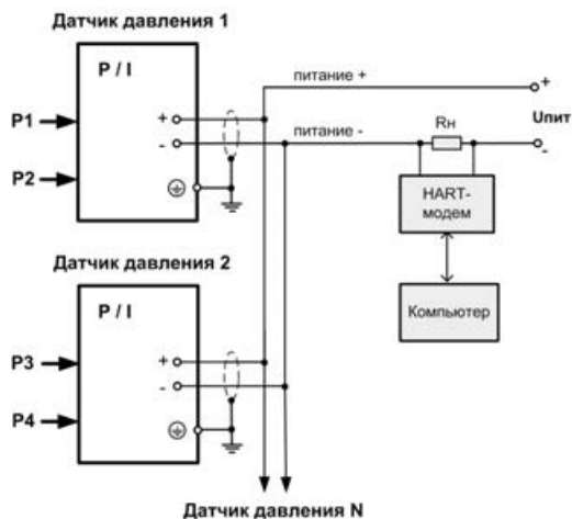
Рисунок В.4 – Подключение нескольких приборов AMZ 5050 к одной линии питания (P1– P4 – давление измеряемой среды)
