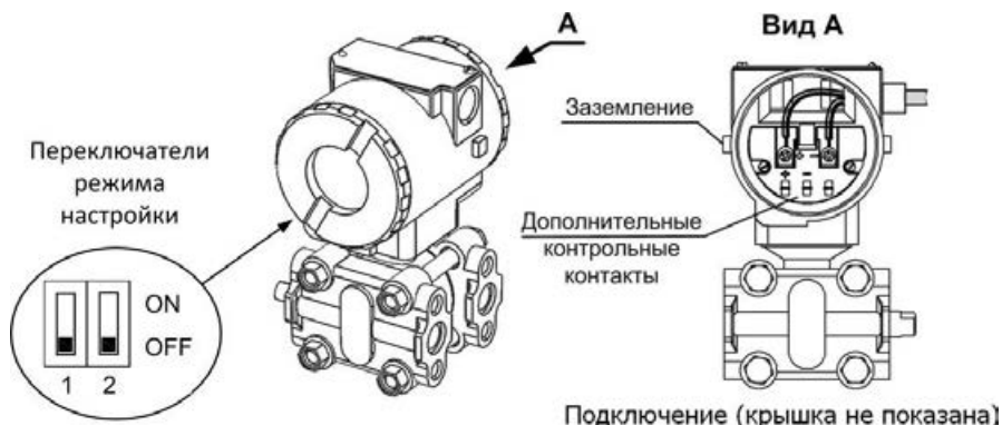
Рисунок В.1 – Расположение контактов на клеммной колодке и переключателей режима настройки под крышками
